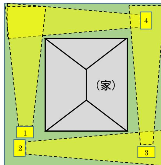
(※) 侵入者検知発信部がレーダー検知すると無線で受信制御部に信号を送信します。(赤外式でなく本格的な電波レーダーです)
